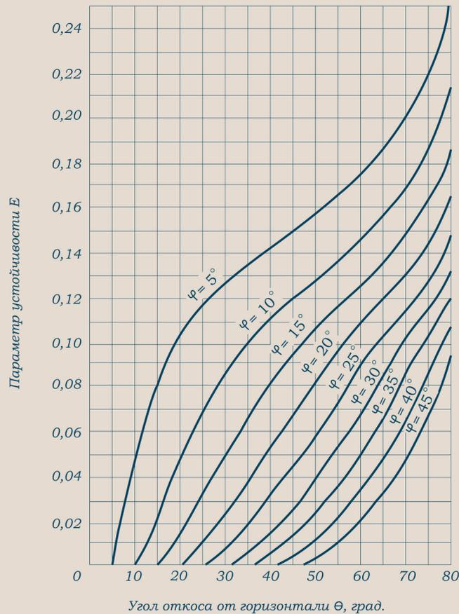
**Черт. 1.** Графики для определения крутизны откоса при  $K = 0$
