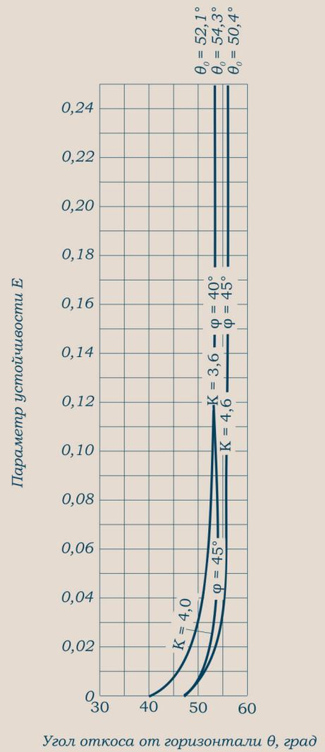
**Черт. 5.** Графики для определения крутизны откоса при  $3 < K < 5$
