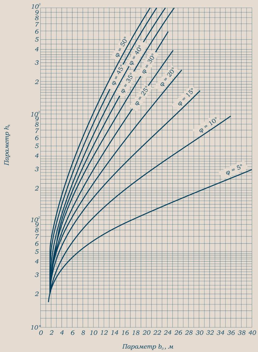
**Черт. 6. Графики для определения параметра  $b_0$**
