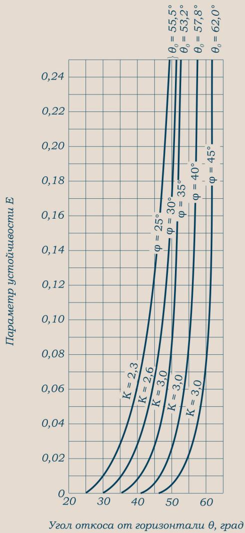
**Черт. 4.** Графики для определения крутизны откоса при  $2 < K < 3$
